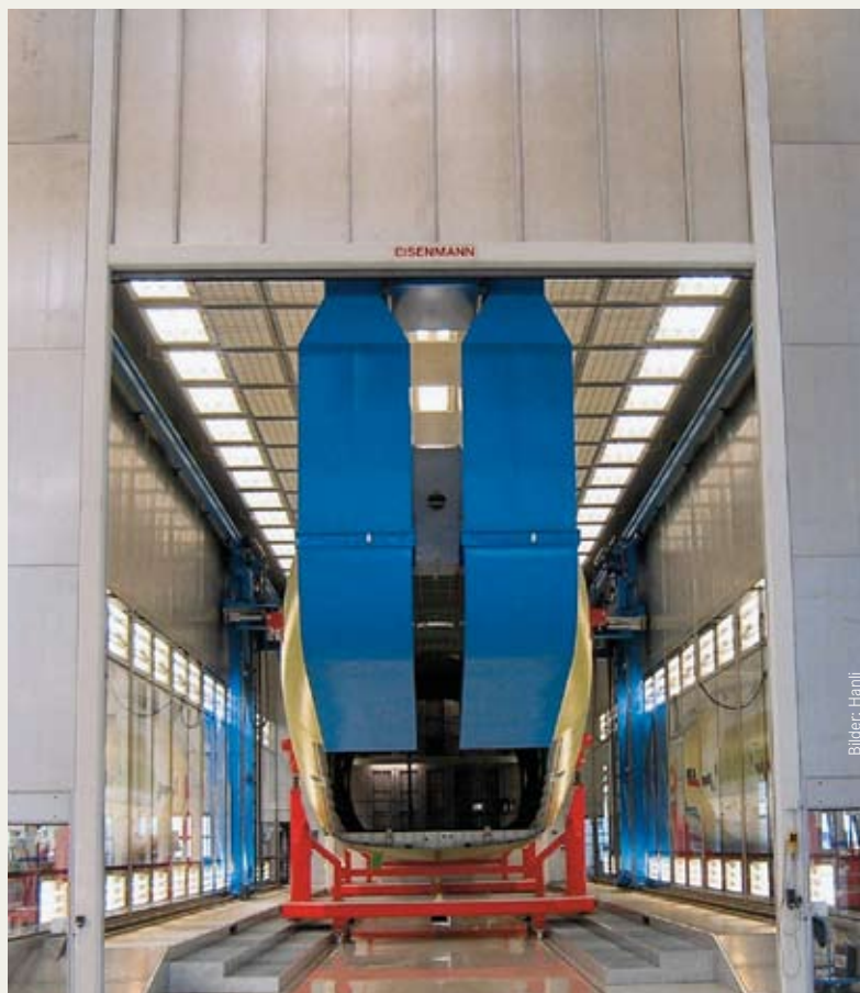
Düsenstrahl: Die Innenbelüftung übernehmen zwei verschiebbare Heckdüsen
