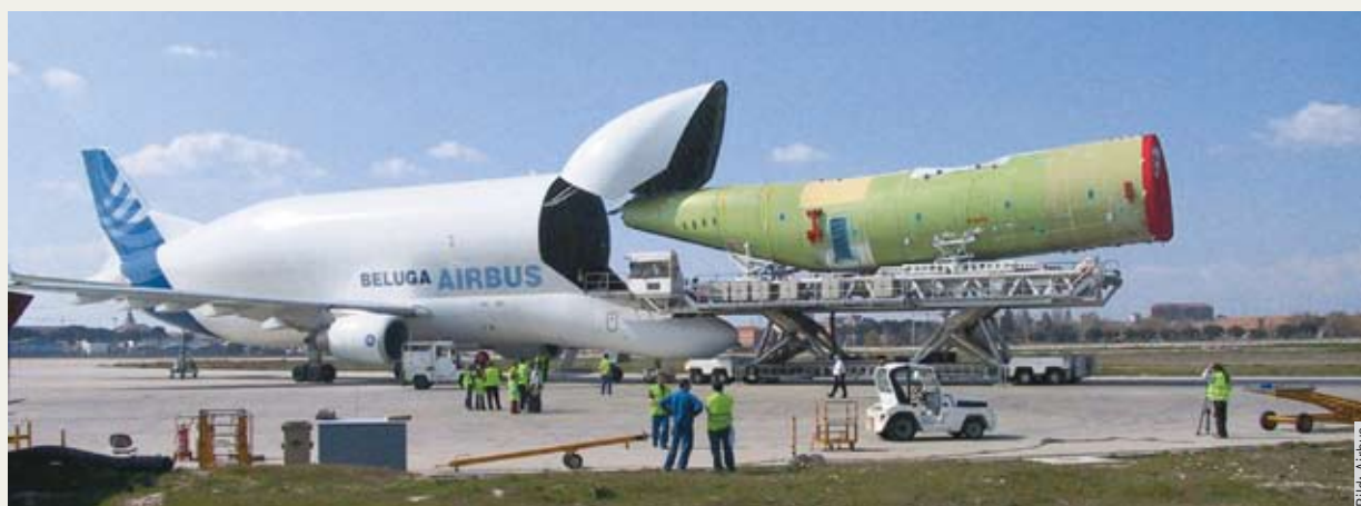
Stückwerk: Der vormontierte Rumpf der großen Transportmaschine wird in Bremen restkonserviert
