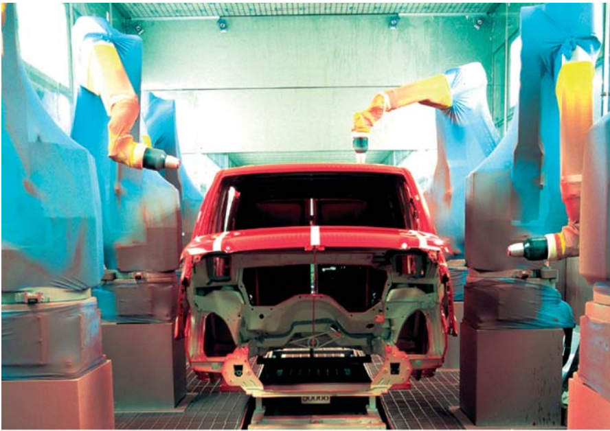
Bild 1. Robotergestützte Decklackierung einer Karosserie
